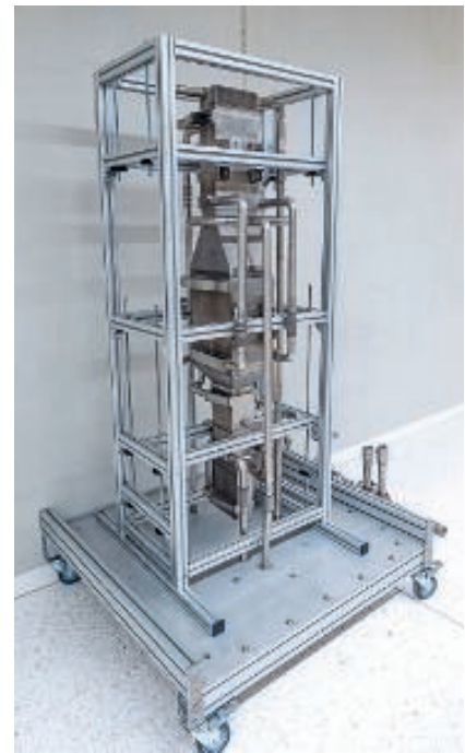
Pilotanlage des Fraunhofer IMM für das Ammoniak-Cracken mit einer Kapazität von 20 kg/h Ammoniak.
