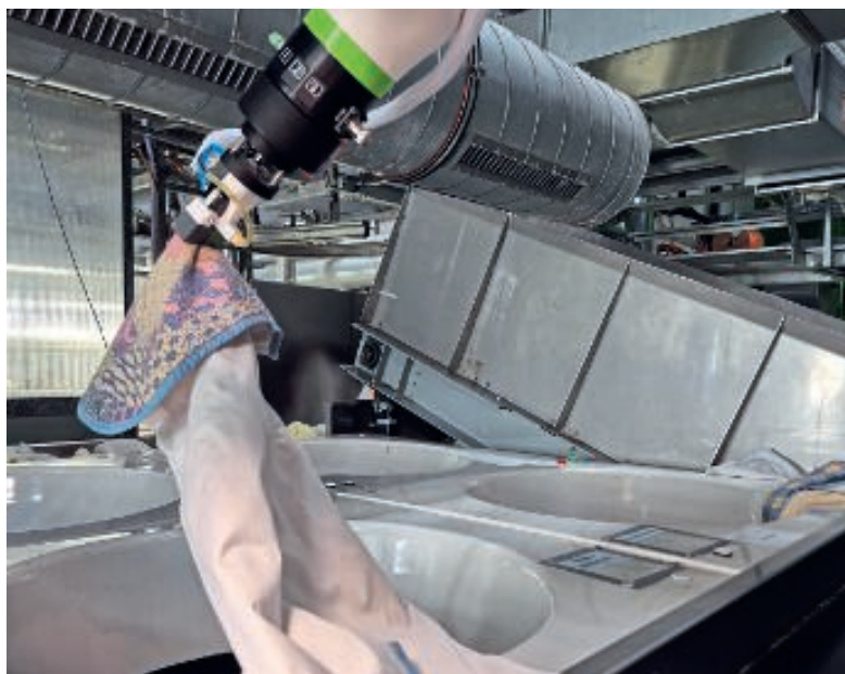
Das Robotersystem sewts.ORDO ermöglicht eine automatisierte Schmutzwäschesortierung.
