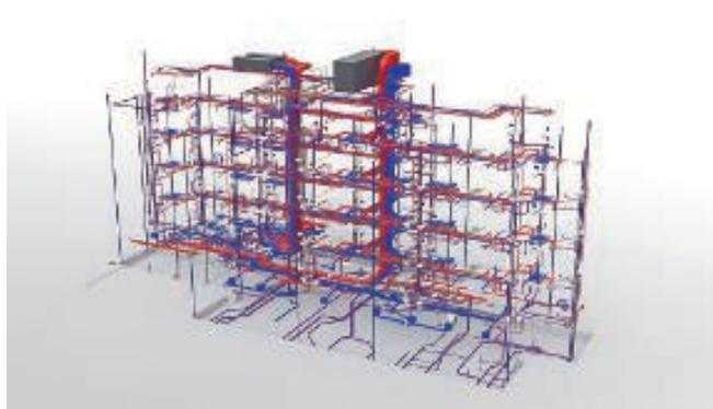
Durch den Einsatz einer Open-BIM-Planungssoftware konnten regelmäßige Kollisionsprüfungen durchgeführt und so zügige und reibungslose Abläufe auf der Baustelle sichergestellt werden.
