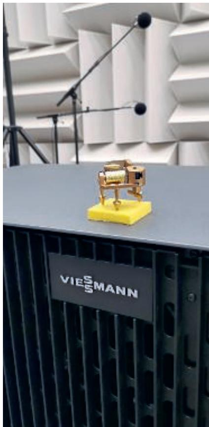
Die leise Spieluhr auf der Wärmepumpe: Entkopplung mit Dämmmaterial zum Gehäuse.
