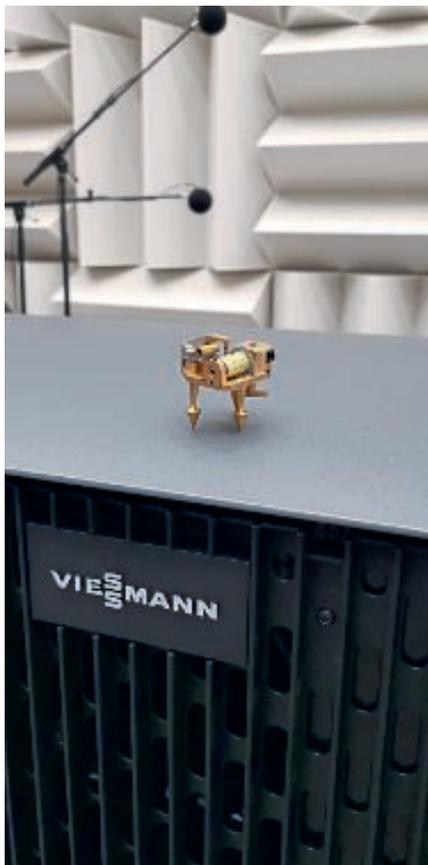
Die laute Spieluhr auf der Wärmepumpe: ohne Dämmmaterial zum Gehäuse.
