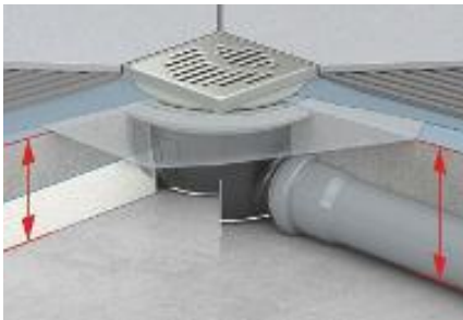
Links ein Geruchsverschluss mit 25 mm Sperrwasser- und 70 mm Einbauhöhe (bis Oberkante Estrich), rechts mit 50 bzw. 90 mm.
