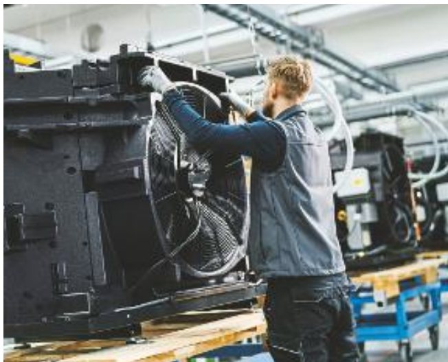
Das Chassis der Wolf CHA besteht aus leichten und robusten EPP-Formteilen. Es sorgt neben der Fixierung der Funktionsbauteile (z. B. Ventilator und Wärmetauscher) auch für eine ideale Luftführung.
