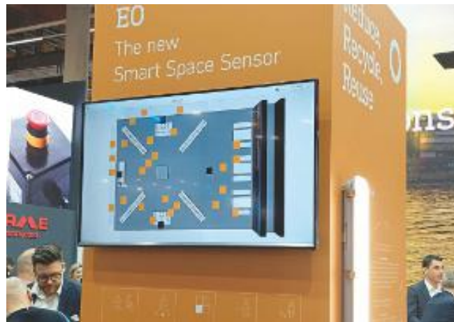
Die Funktionsweise des Multisensors EO mit Zonenfunktion von Steinel, der die Lage von Personen innerhalb eines Rasters ermittelt, wurde auf einem Bildschirm am Messestand dargestellt.
