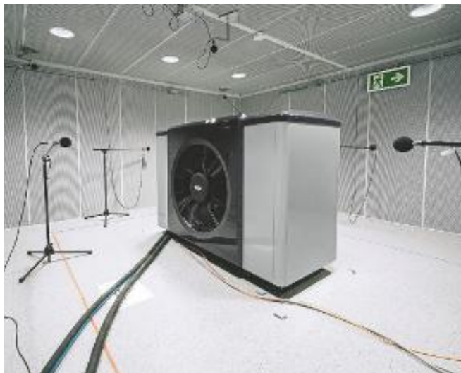
Das Wolf-Schalllabor ist entsprechend der Norm ISO 3744 für Schallleistungsmessungen der Genauigkeitsklasse 2 zertifiziert. Der Schallleistungspegel der Geräte wird entsprechend dieser Norm (ISO 3744) durch das Hüllflächenverfahren mit mindestens neun Mikrofonen bestimmt.
