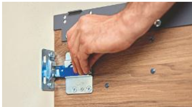
Ein blauer Sicherheitsverschluss verhindert das Aushängen des Badmöbels. Er ist vormontiert und lässt sich durch einen Schiebeverschluss einfach einrasten.
