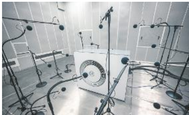
Blick in das Akustiklabor für Wärmepumpen bei Bosch Home Comfort in Wernau. Die Ausgaben für Forschung und Entwicklung wurden im vergangenen Jahr gegenüber 2022 um 19 % auf 256 Mio. Euro gesteigert.
