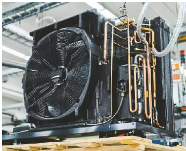
Der Verdichter einer Wolf CHA ist durch spezielle Schwingungsdämpfer doppelt vom Gehäuse schallentkoppelt und zusätzlich mit Akustik-Vlies ummantelt.
