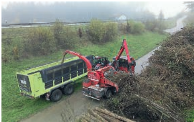
Landschaftspflege und Holzernte – die Maschinen des Forstunternehmers Maier im Einsatz. Die produzierten Hackschnitzel versorgen die Gemeinde mit Wärme.
