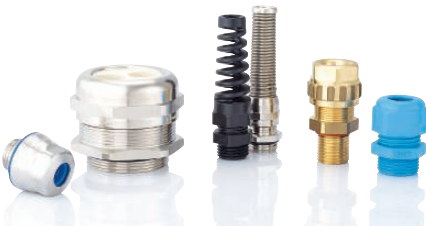
HD-Verschraubung für hygienisch sensible Anwendungen, Multi-Verschraubung zur Durchführung mehrerer Kabel, zwei Knickschutzverschraubungen für bewegungsintensive Einsatzorte wie z. B. Wallboxen, Exios A2F für explosionsgefährdete Bereiche ohne armiertes Kabel und blaue HSK-K-Kunststoffverschraubung (v. l.).
