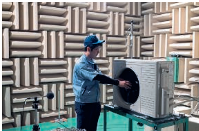
Ein Mitarbeiter testet ein Klimagerät im Soundlabor des Werks Tochigi, Japan, von Johnson Controls-Hitachi Air Conditioning.
