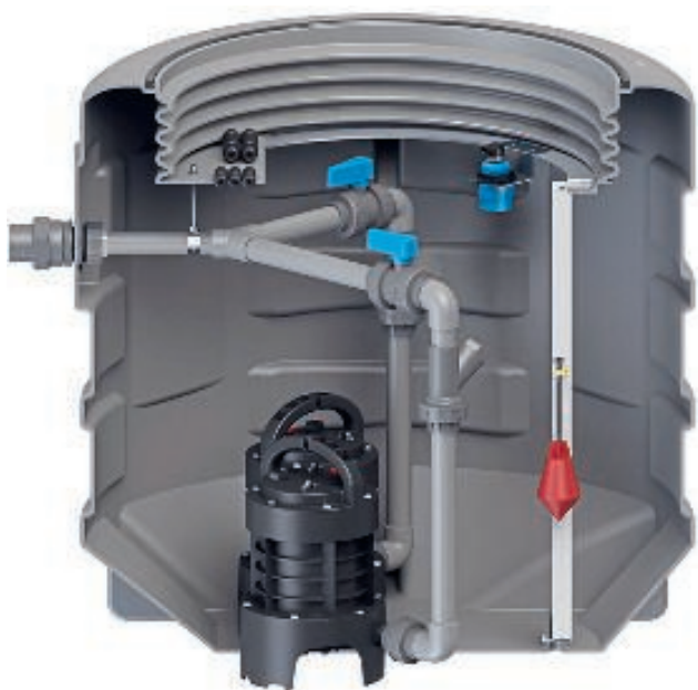
Die Pumpstation Sanifos 610 ist mit einer oder zwei Pumpen erhältlich. Das Radarmodul zur millimetergenauen Füllstandsmessung ist oben am Rand der Pumpstation angebracht. So kommt es mit dem Abwasser nicht in Berührung und garantiert eine maximale Betriebssicherheit.
